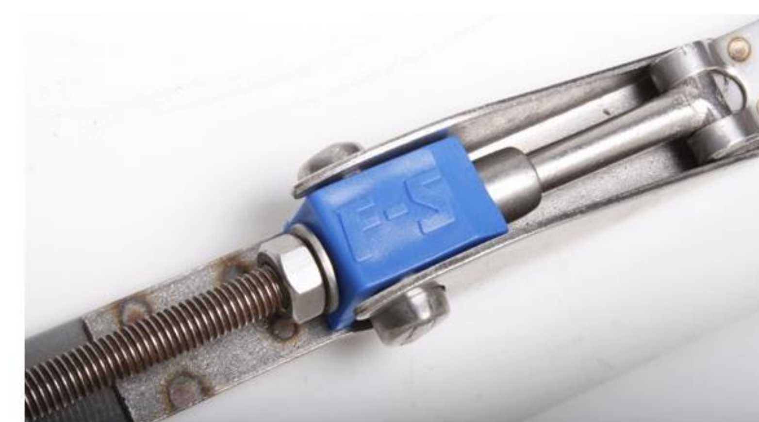
Fra 1000 mm bespændes med 20 Nm.
