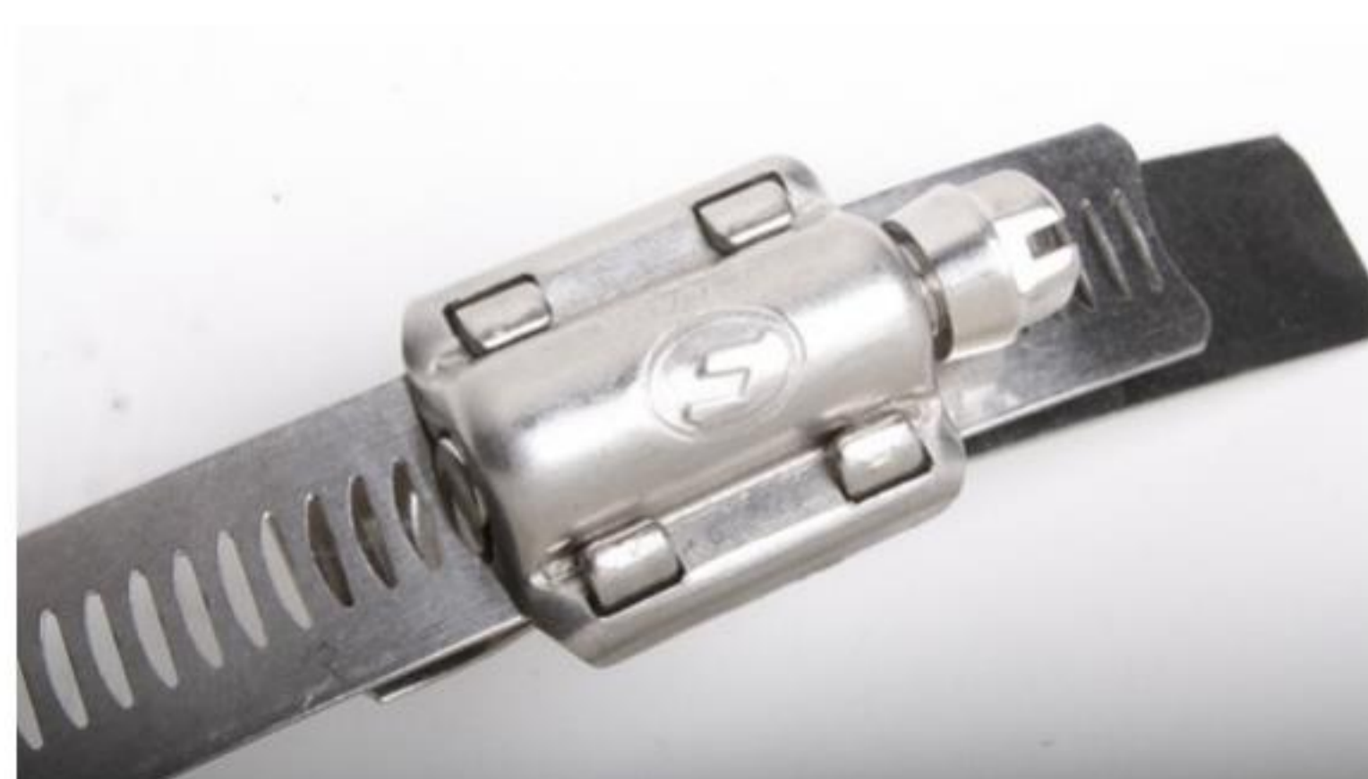
Fra 500-1000 mm bespændes med 12 Nm.
