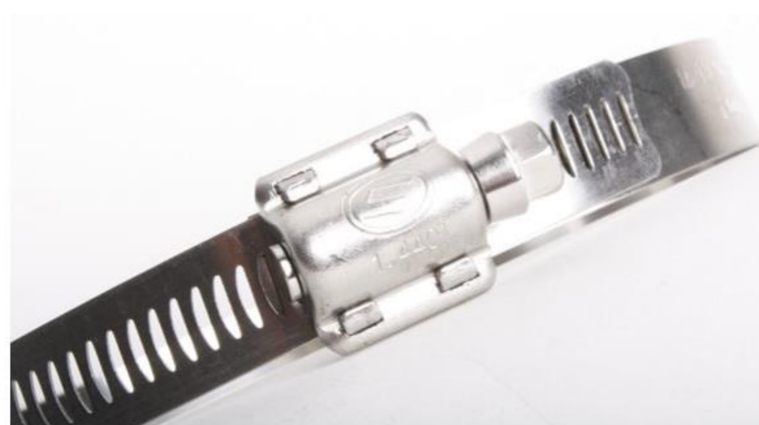
Fra 400-500 mm bespændes med 7 Nm.
