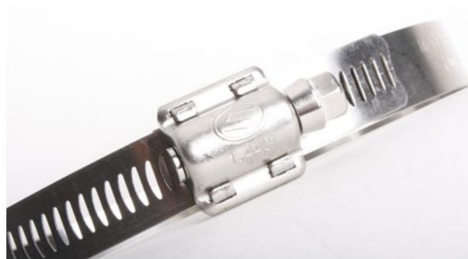
Fra 400-500 mm bespændes med 7 Nm.
