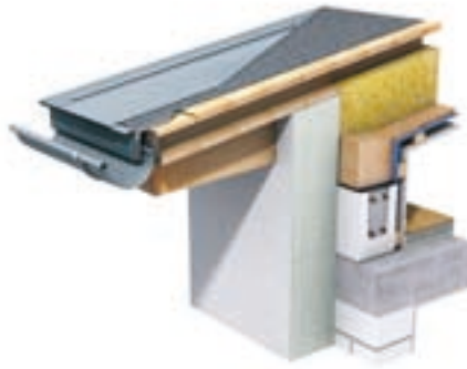
Fig. 1: Ventileret tagkonstruktion med isolering mellem spærene
