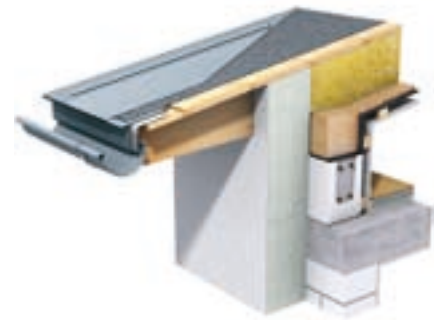
Fig. 2: Ikke-ventileret tagkonstruktion med fuld isolering af spærene
